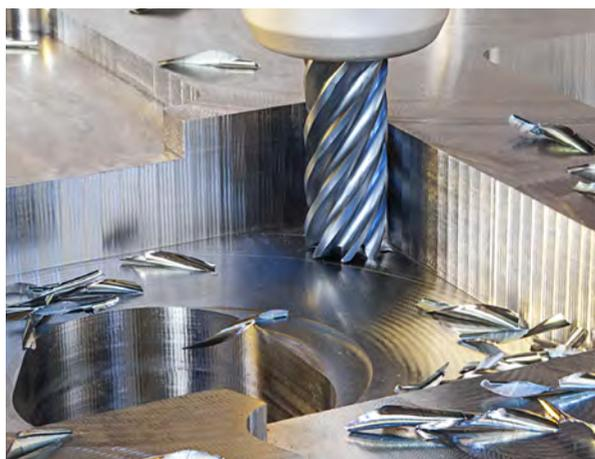
Fig. 24 Trochoidal milling
